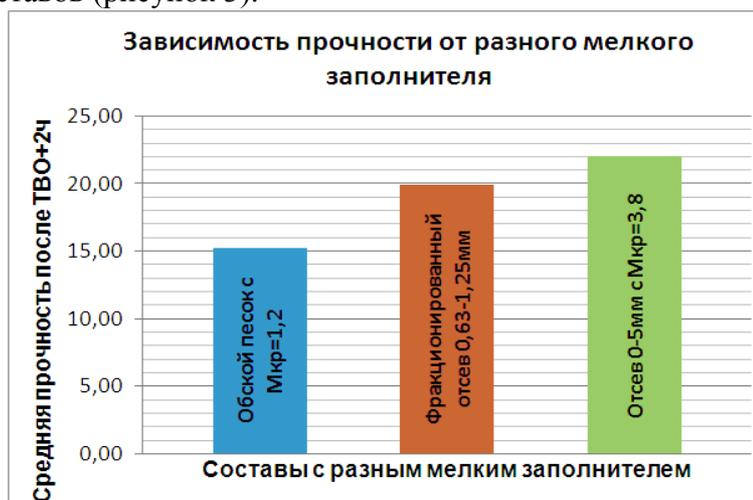
Рисунок 3 – Зависимость прочности от мелкого заполнителя
