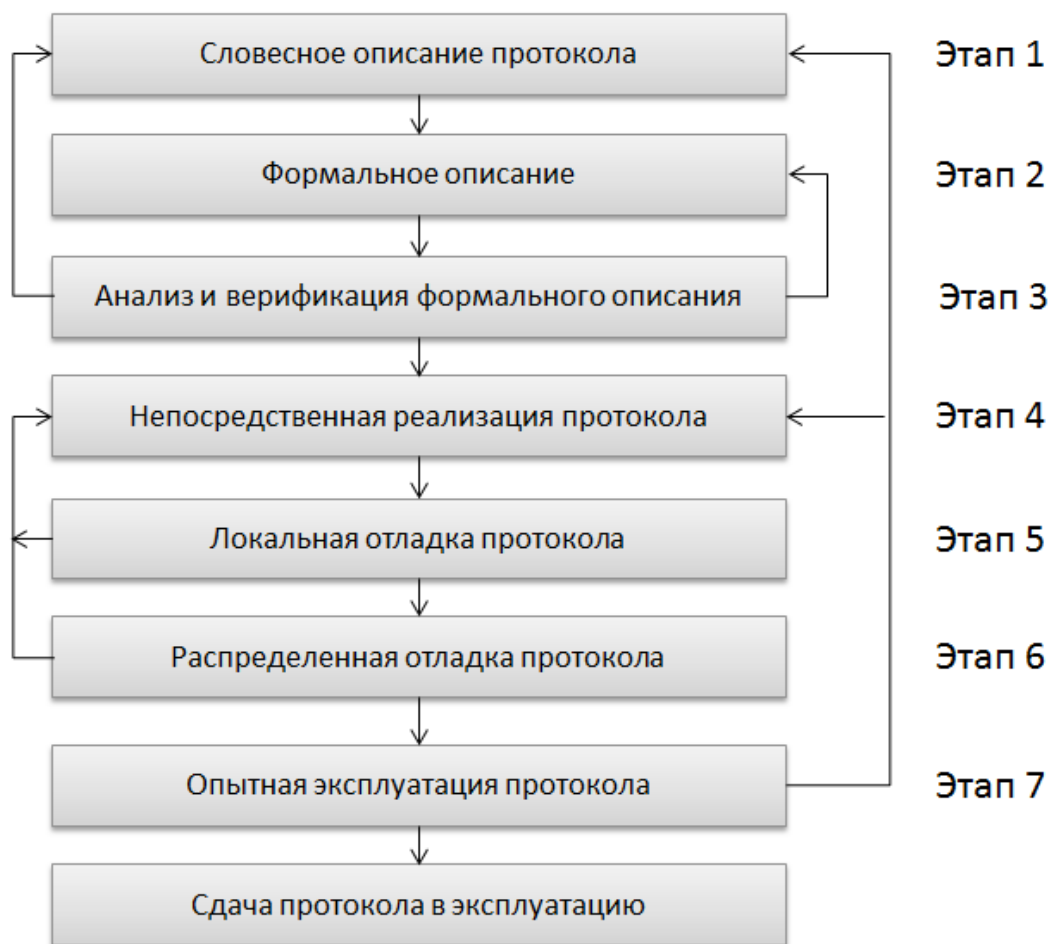
Рисунок 1 – Технологический цикл разработки протоколов
