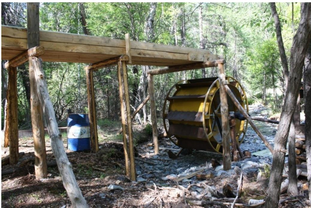
Рисунок 2 – Фото водоналивного колеса и подводящего лотка (вид сзади)
