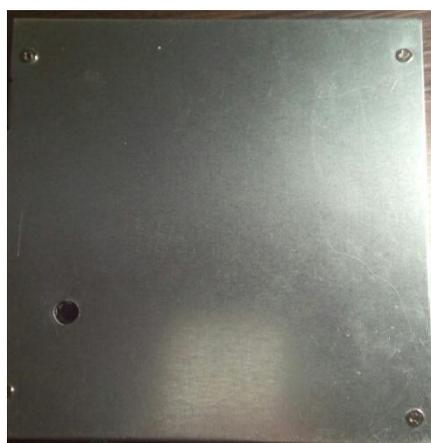
Рисунок 3. Верхняя сторона с отверстием для датчика температуры
