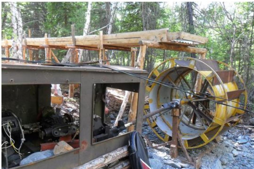
Рисунок 1 – Фото водоналивного колеса и подводящего лотка (вид сбоку)
