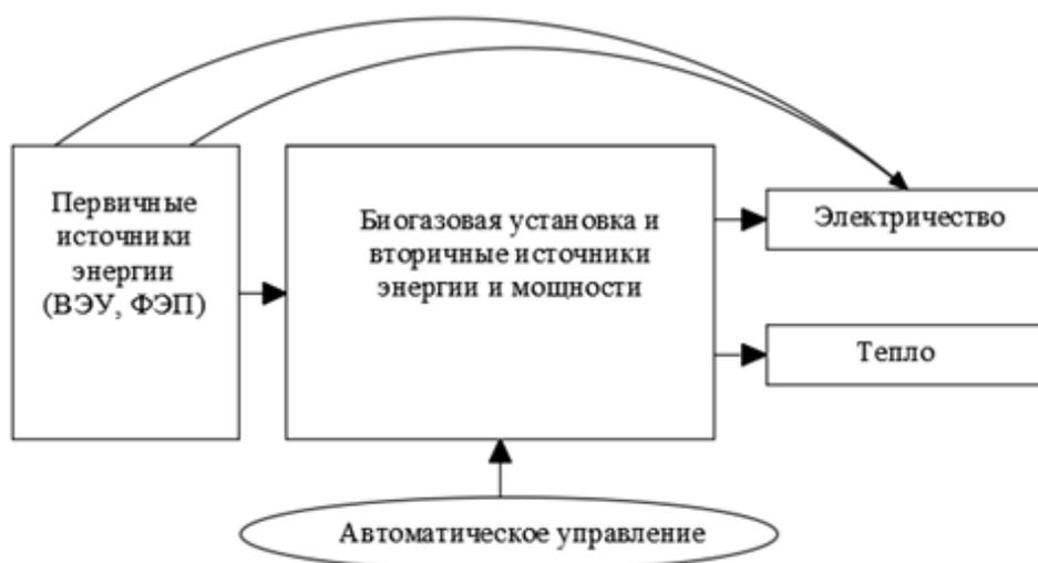
Рисунок 1. Упрощенная структура автономной энергоустановки на ВИЭ
