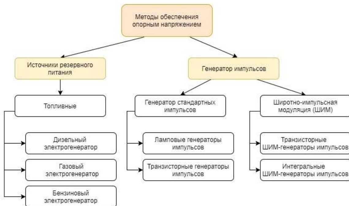
Рисунок 1 – Методы обеспечения ведомых инверторов опорным напряжением
