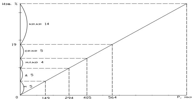
Рисунок 4 - Зависимость  $I_{3B}$  от  $P$  для второй драной системы
