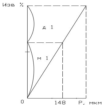
Рисунок 6 - Зависимость  $I_{3B}$  от  $P$  для четвертой драной системы
