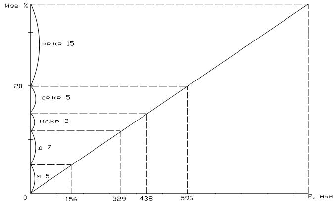
Рисунок 3 - Зависимость  $I_{3B}$  от  $P$  для первой драной системы
