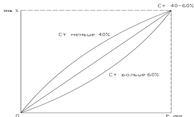
Рисунок 1 - График баланса драной системы
