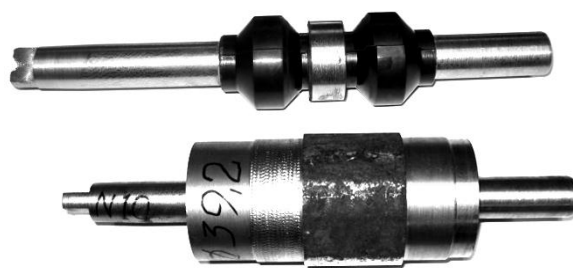
Рисунок 2 - Лабораторный образец: а – резинометаллический палец; б – резинометаллический шарнир в сборе
