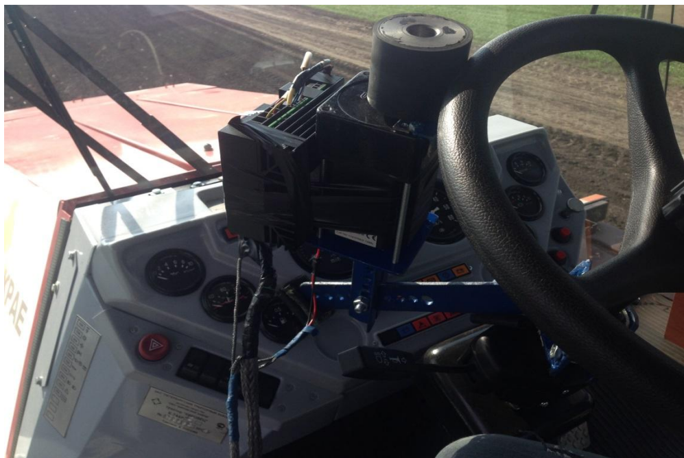
Рисунок 4 - Электромеханический привод подруливающего устройства (полевые испытания)
