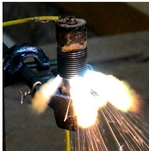
Рисунок 2 – Горение отработанного моторного масла в устройстве смесеобразования и воспламенения
