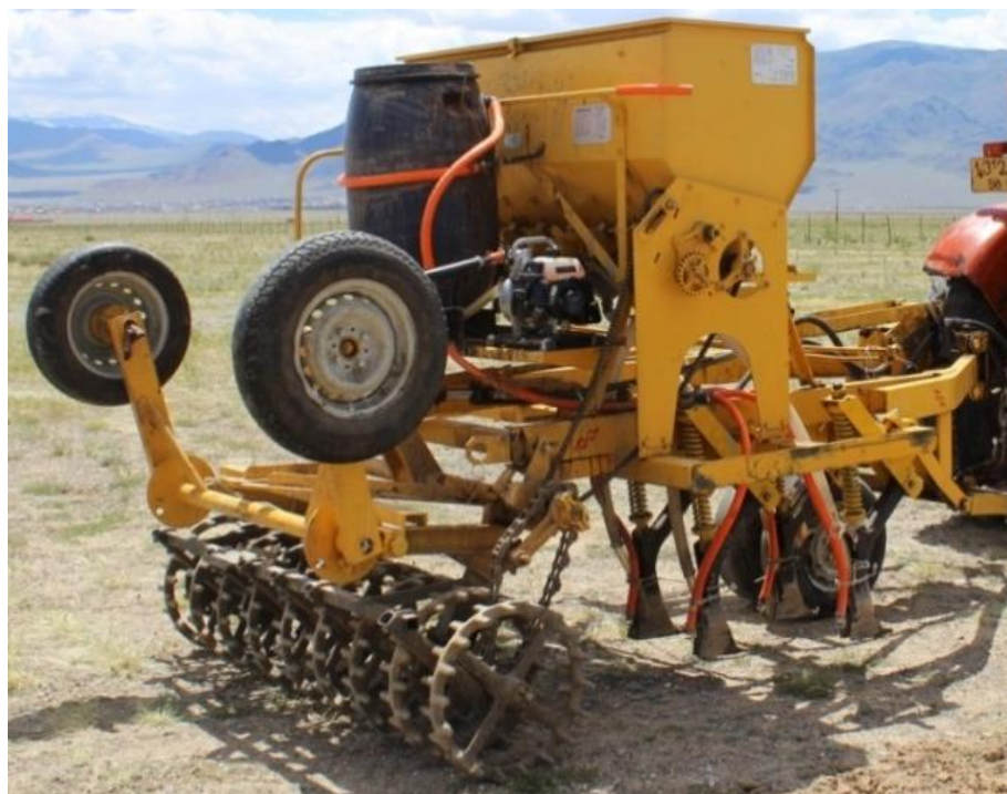
Рисунок 1 - Зерновая сеялка СКП-2,1 «Омичка» с установленным оборудованием для внесения ПВК в почву
