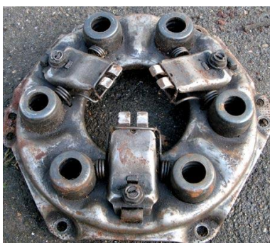
Рисунок 1 - Изменение форм отжимных рычагов Рисунок 3 - Напайка на лапке отжимного рычага
