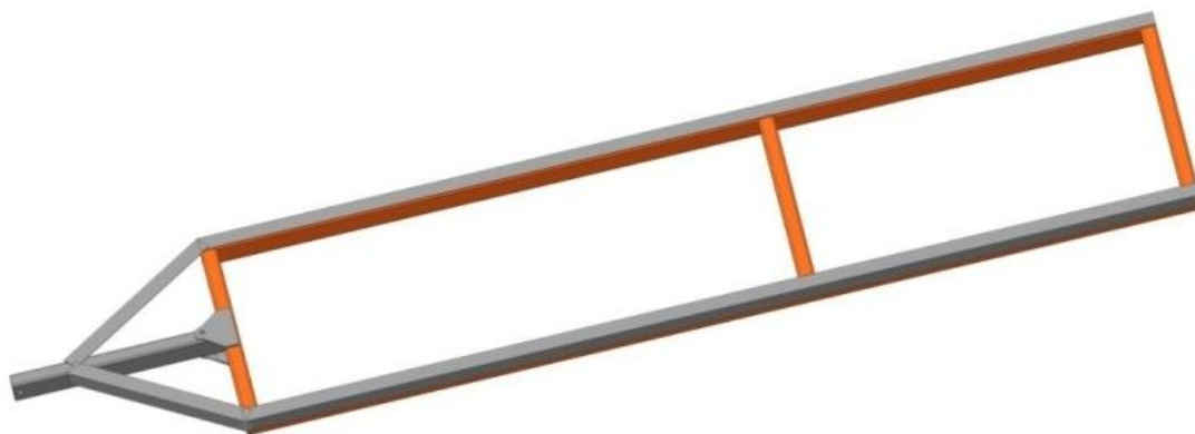
Рисунок 4-Усиленная рама картофелеуборочного комбайна
