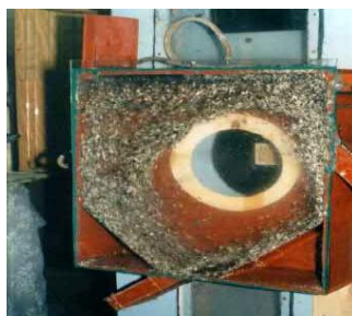
Рисунок 6 - Вихревой способ сжигания лузги подсолнечника
