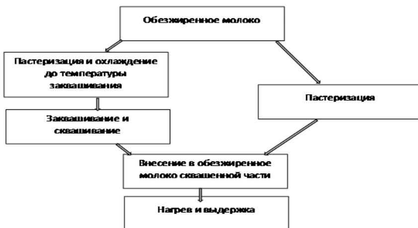
Рисунок 1 - Схема разделения и сквашивания молока
