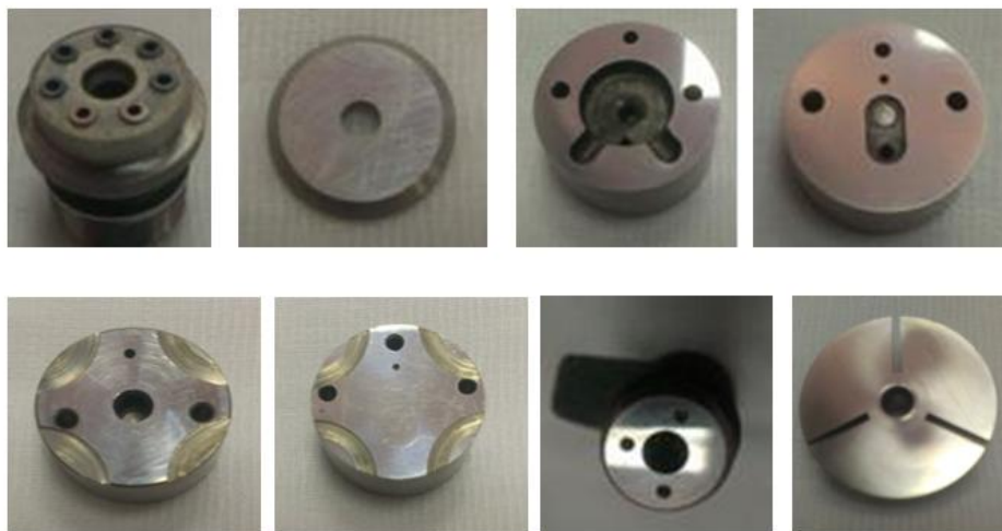
Рисунок 2 – Примеры деталей топливной аппаратуры с высокими требованиями к геометрическим параметрам качества поверхности
