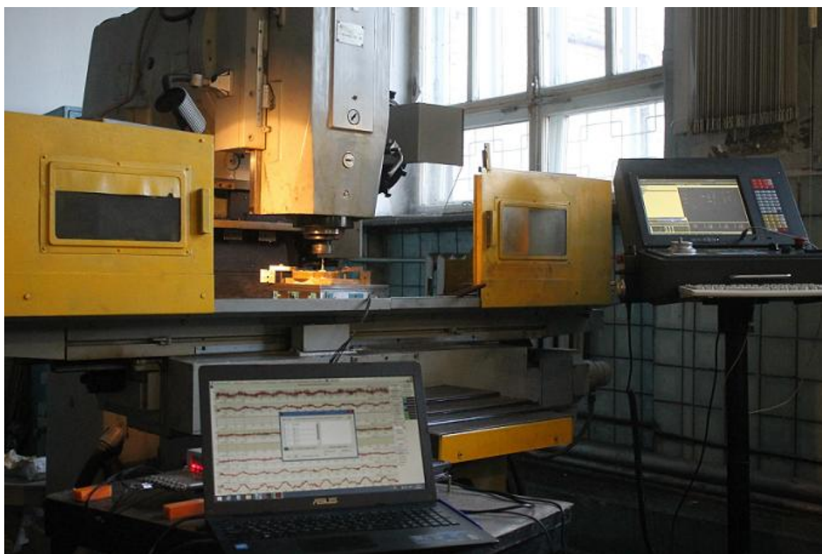
Рисунок 1 - Процесс сверления стеклопластика, автоматизированный стенд сбора и обработки информации
