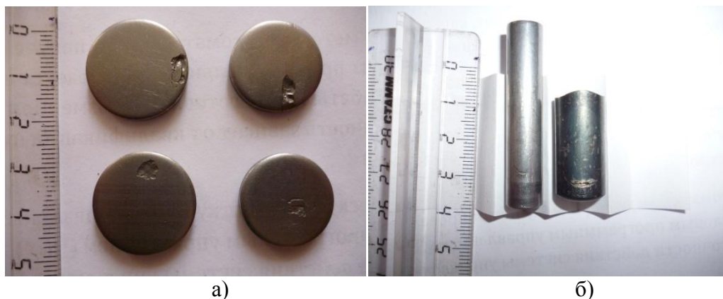
Рисунок 1 – Дефекты заготовки: а) обнаруживаемые сразу; б) проявляющиеся в процессе производства
