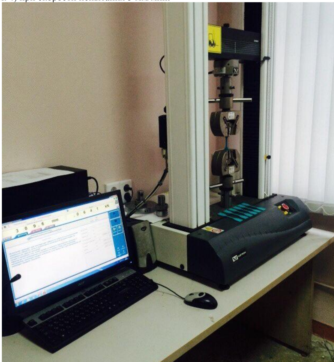
Рисунок 4 – Испытание на растяжение образцов
