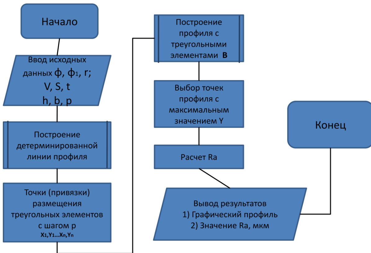
Рисунок 2 – Алгоритм расчета микропрофиля обработанной поверхности при точении
