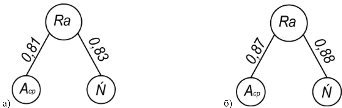
Рисунок 2. – Графы связей шероховатости Ra от параметров сигнала АЭ: скорости счета \dot{N} и средней амплитуды A_{cp} для демпфирующих элементов из а) стали и б) резины
