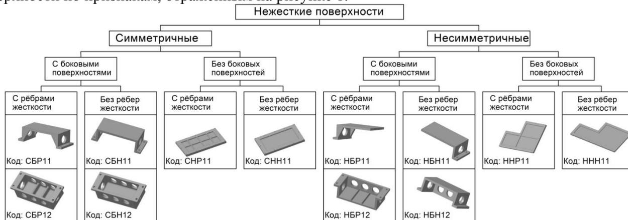
Рисунок 1 – Классификация нежестких поверхностей деталей машин
