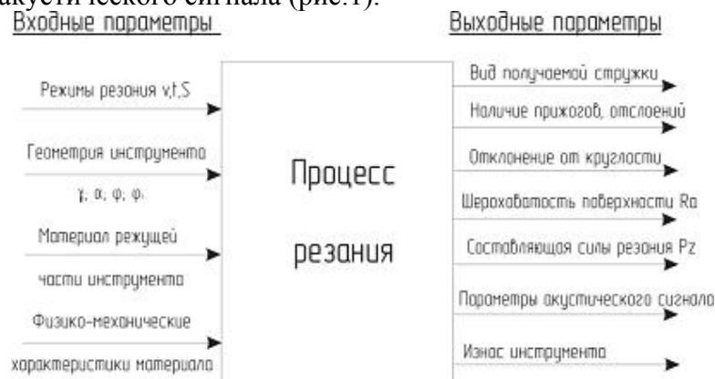
Рисунок 1 – Входные и выходные параметры процесса резания
