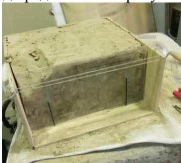
Рисунок 1.1- Испытательный стенд с образцом грунта ненарушенной структуры.
