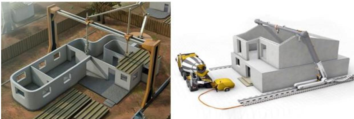
Рисунок 1 – Модель 3D-принтера Бероха Хошневиса. [1]
