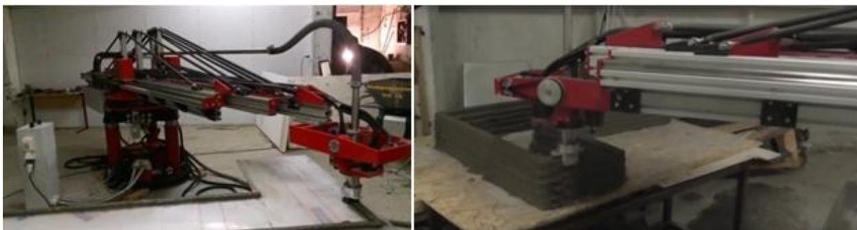
Рисунок 5 – Прототип 3D-принтера Aris Cor.
