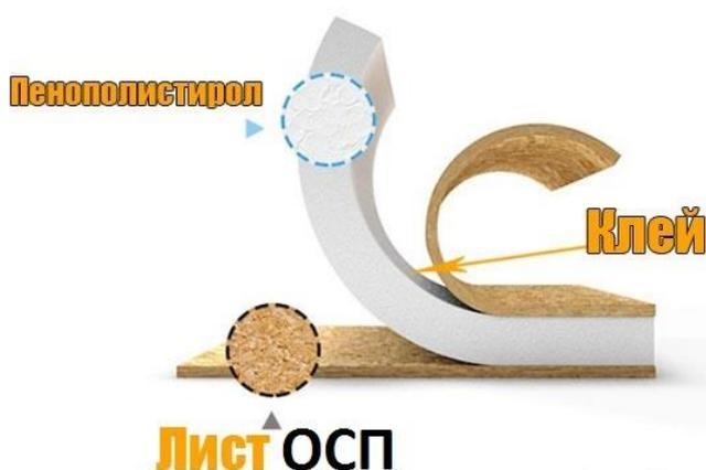
Рисунок 2 - Структура SIP-панели
