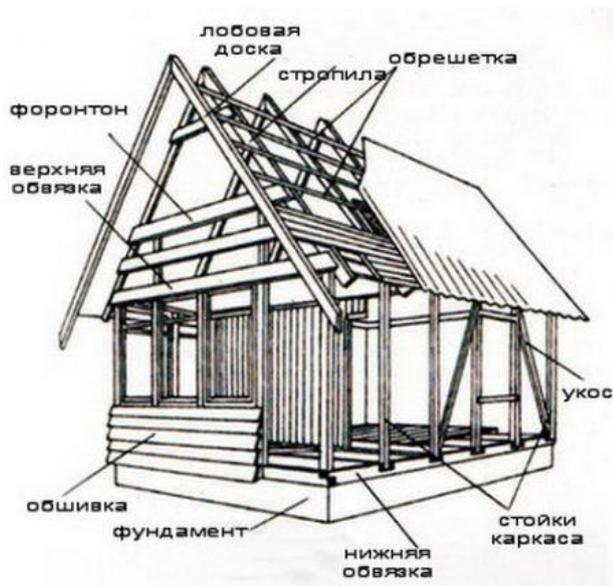
Рисунок 1 - Составляющие каркасного здания
