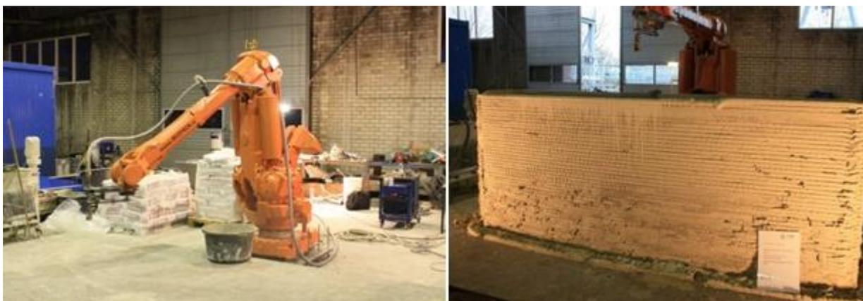
Рисунок 6 – Робот-манипулятор ProTo R 3DP. [6]
