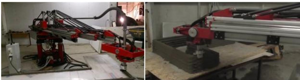
Рисунок 5 – Прототип 3D-принтера Aris Cor.
