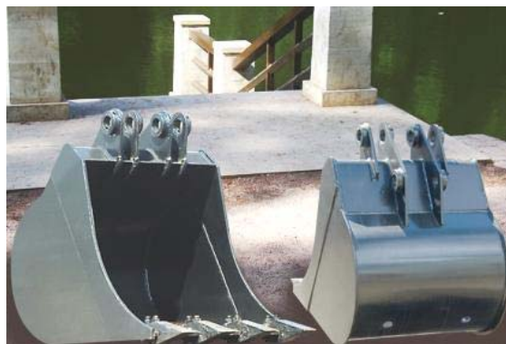
Рисунок 1 – Ковш экскаватора: а) восстановленный; б) упрочненный
