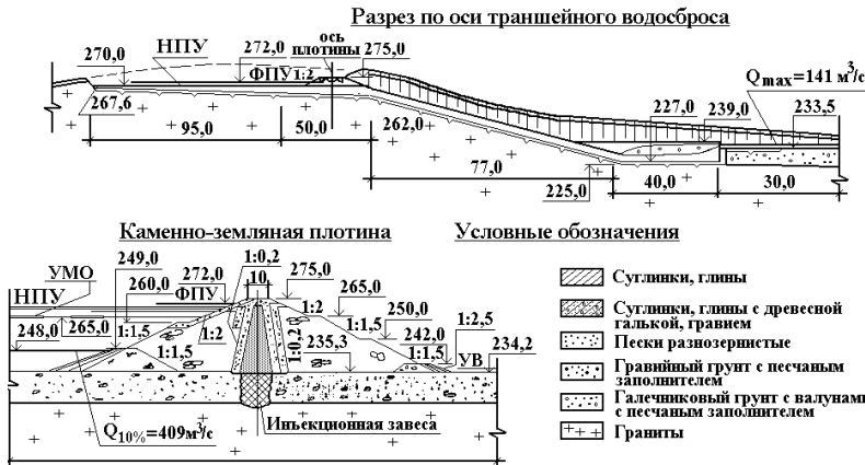
Рисунок 3 - Разрезы по осям Красногородской ГЭС на р.Песчаной
