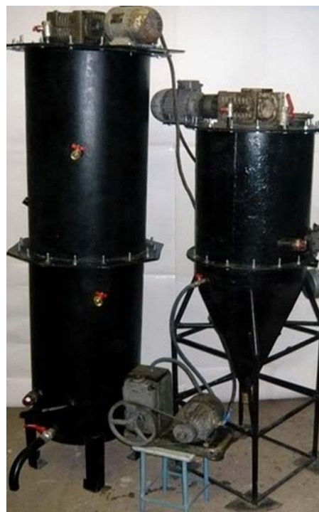
Рисунок 1 – Установка по переработке осадков сточных вод
