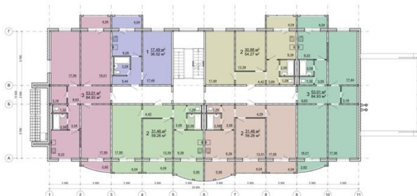
Рисунок 1 – План типового этажа жилого дома по ул. Смирнова, 67 в г. Барнаул
