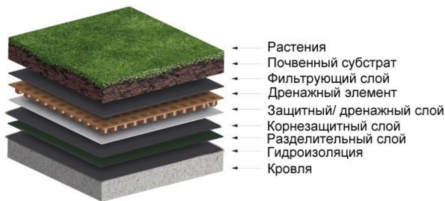
Рисунок 13 – Состав озеленённой кровли
