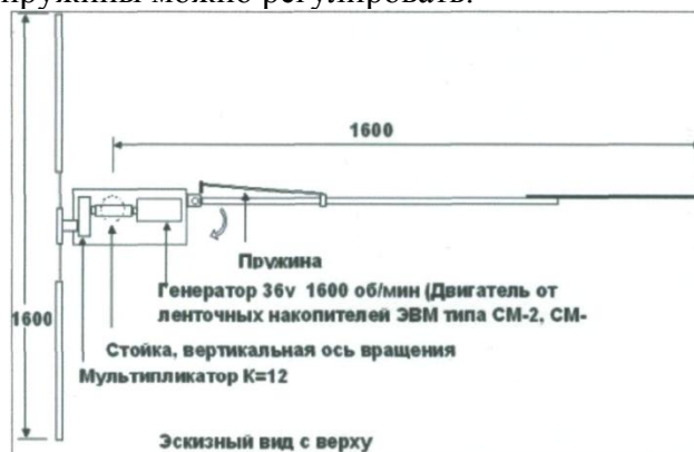
Рисунок 2 – Устройство хвоста ветроколеса
