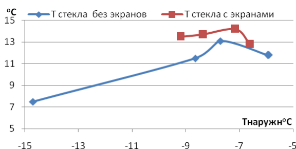
Рисунок 3 - Температуры остекления при открытом и закрытом экране
