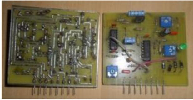
Рисунок 1. Блок регулирования и управления напряжением (БРУН)
