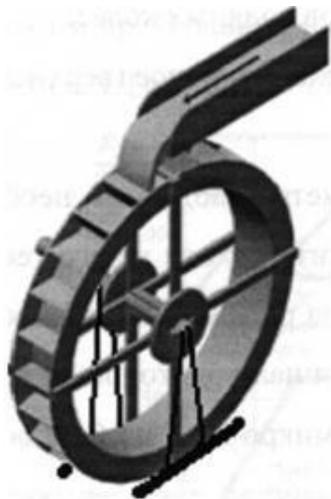
Рисунок 1 - Верхненаливное водяное колесо
