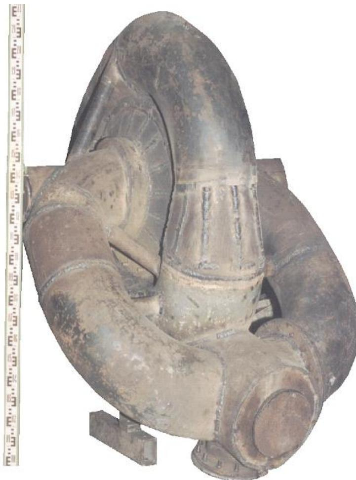
Рис.1. Рабочая модель радиально-осевой гидротурбины в натуральную величину
