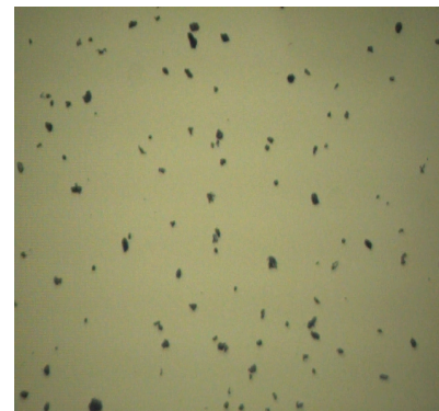
Рисунок 3 – Изображение частиц муки, полученное с микроскопа
