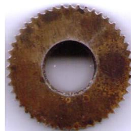
Рисунок 4 – Накатной ролик
