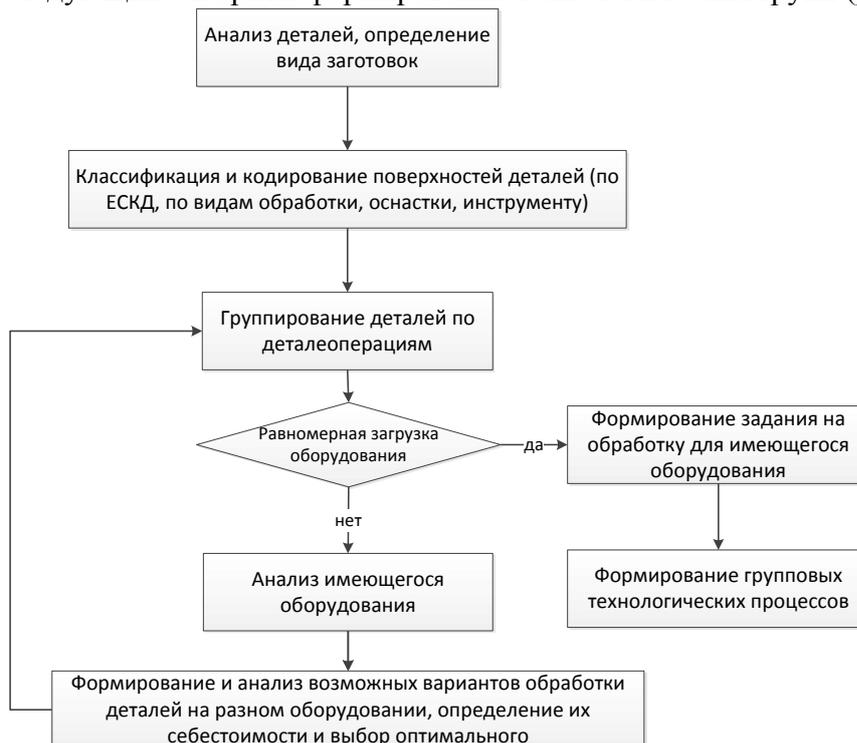
Рисунок 1 – Алгоритм проектирования группового технологического процесса
