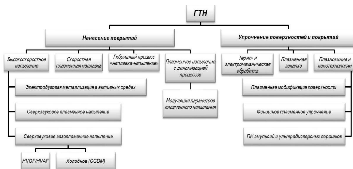
Рисунок 1 – Прогрессивные газотермические методы нанесения покрытий(ГТН) и упрочнения поверхностей деталей машин.
