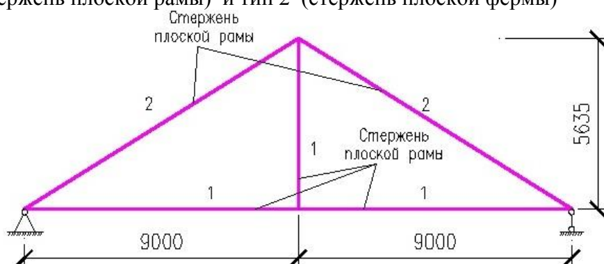
Рисунок 1- Геометрическая компоновка рамы
