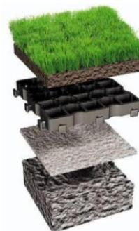
Рисунок 1 – Конструкция экопарковки
