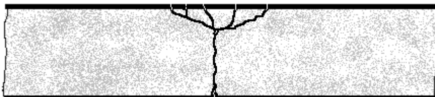
Рисунок 1 – Схема разрушения цементобетонного покрытия в зоне трещины
