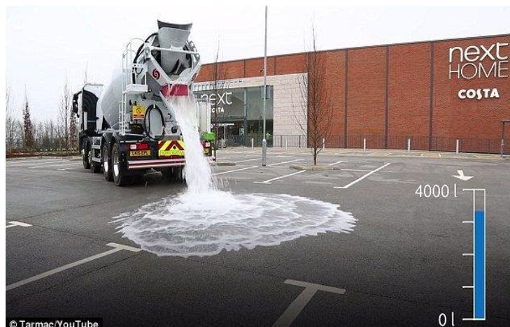
Рисунок 1 – Проверка водопропускных качеств асфальтобетонного покрытия
