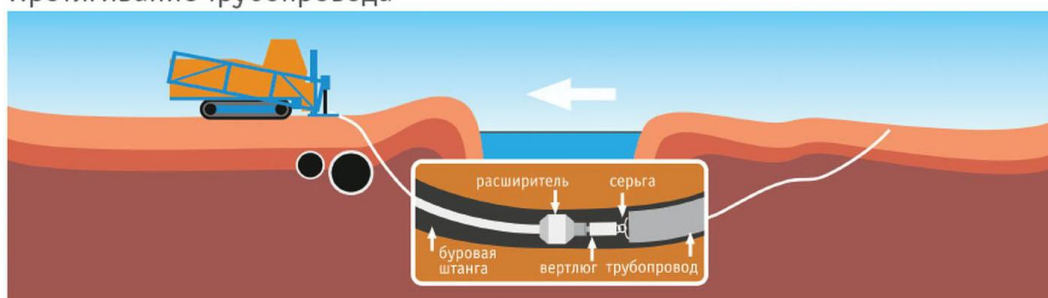
Рисунок 1- Этапы строительства по технологии НГБ
