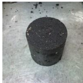
Рисунок 2 – Образец асфальтобетона на битуме с добавкой ПАВ
