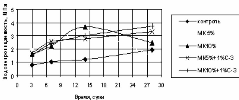
Рисунок 4 - Влияние микрокремнезема на водонепроницаемость
