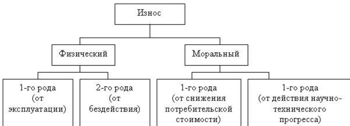
Рисунок 1 - Классификация видов износа
