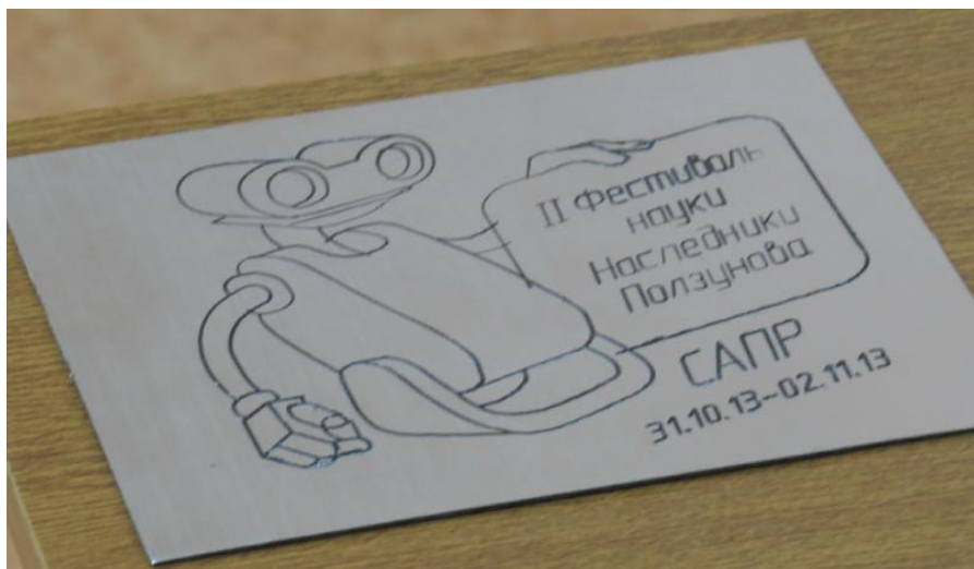
Рисунок 3 – Пример гравировки на двустороннем пластике
