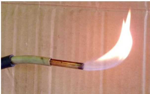
Рис. 2 – Сжигание генераторного газа, выделяющегося при температуре процесса газификации 350 °С
