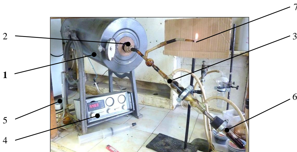
Рис. 1 – Внешний вид лабораторной установки газификации: 1 – трубчатая печь; 2 – реактор газификации; 3 – система охлаждения и газоочистки; 4 – блок управления; 5 – воздуходувка; 6 – приемная колба для конденсата, 7 – штуцер для отбора проб генераторного газа и его сжигания
