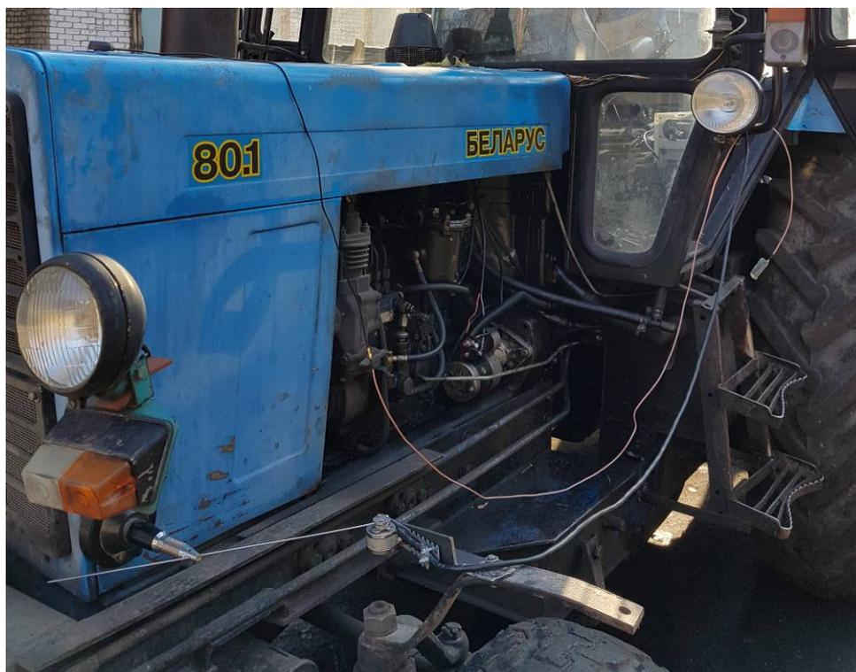
Рисунок 3 – Крепление датчика угла поворота и антенны навигационного приемника
