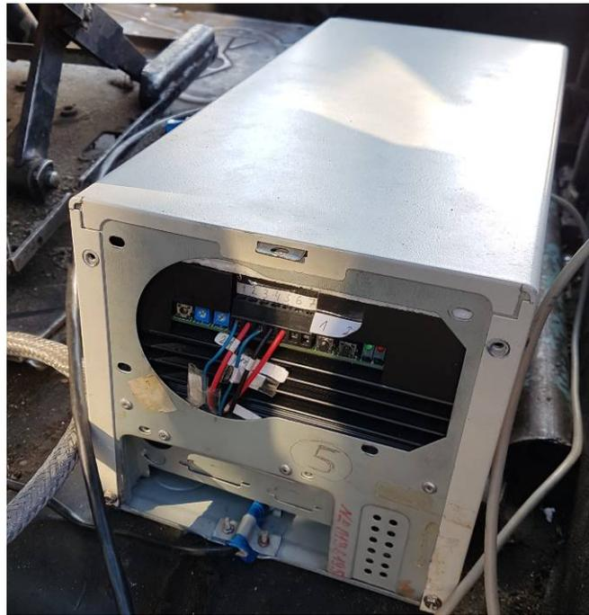
Рисунок 4 – Блок управляющей аппаратуры, содержащий ЦАП/АЦП, блок управления двигателем и преобразователь напряжения
