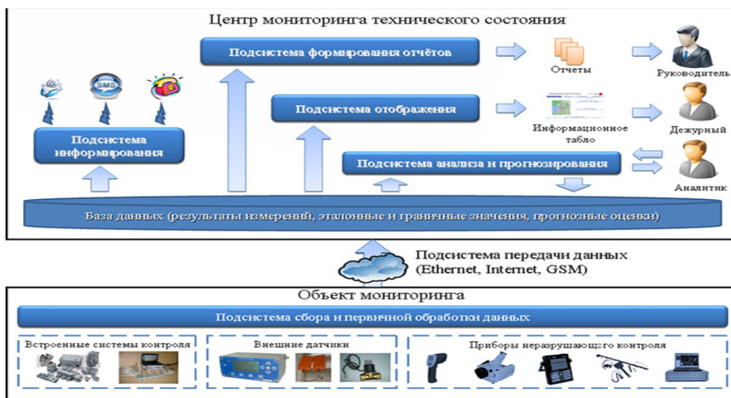
Рисунок 1 – Архитектура автоматизированной системы мониторинга
