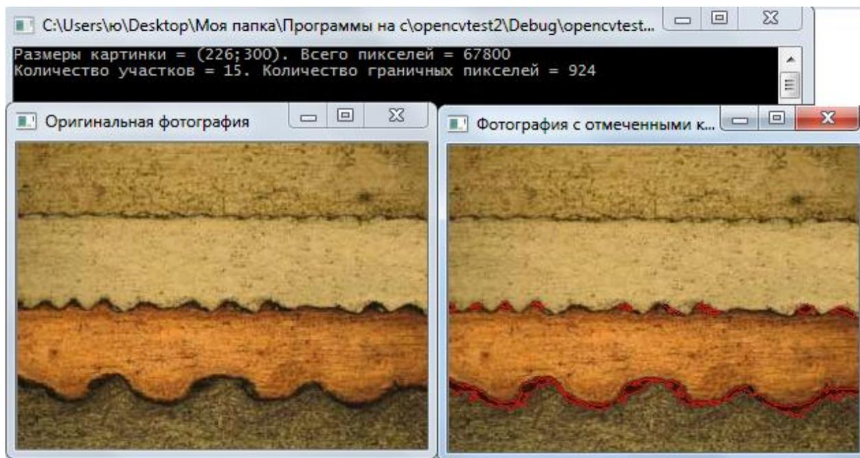
Рисунок 1 – Исходная фотография, фотография с выделенными контурами и результаты численного анализа
