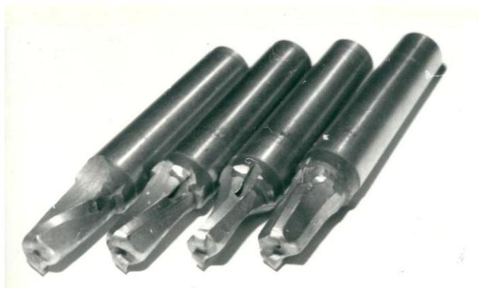
Рисунок 1 – двузубые концевые фрезы с пластинками твёрдого сплава ВК8 и углами  $\omega$  наклона зубьев  $-6^\circ$ ,  $+6^\circ$ ,  $+12^\circ$ ,  $+18^\circ$ .
