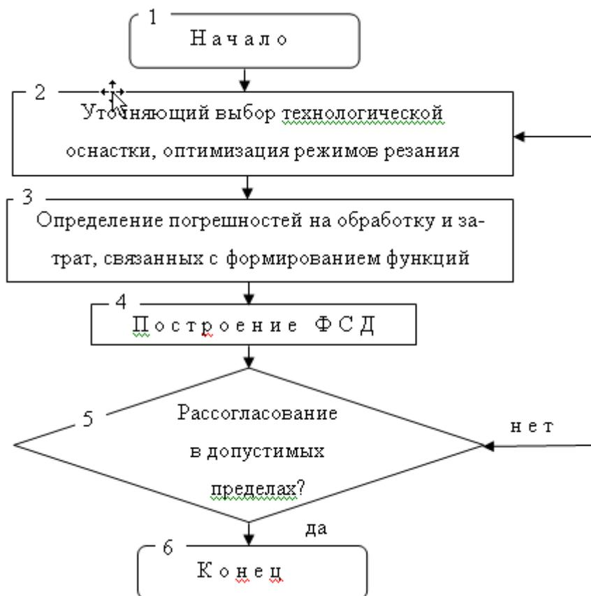
Рисунок 1 – Алгоритм выбора технологической оснастки и режимов резания
