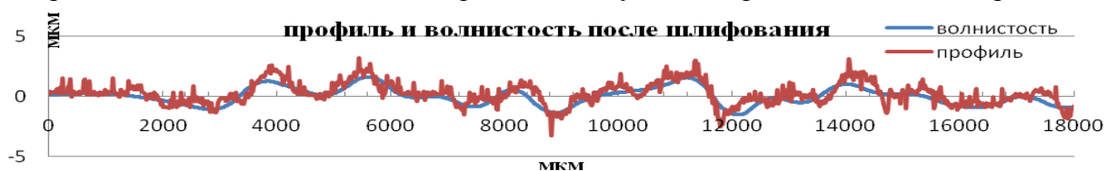
Рисунок 2. Профиль и волнистость анализируемой поверхности
