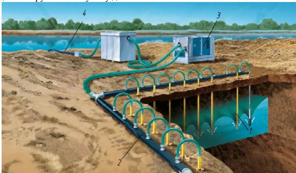
Рис. 2 - Схема иглофильтровой установки
