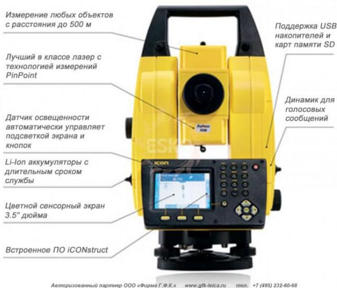
Рис. 2 – Тахеометр Leica iCON builder серии 60
