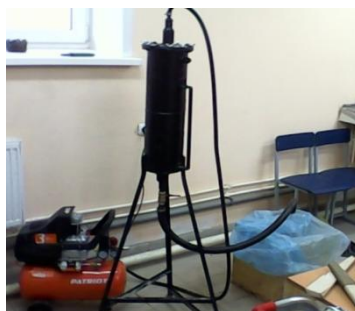
Рисунок 1-Установка для инъектирования грунта в лабораторных условиях
