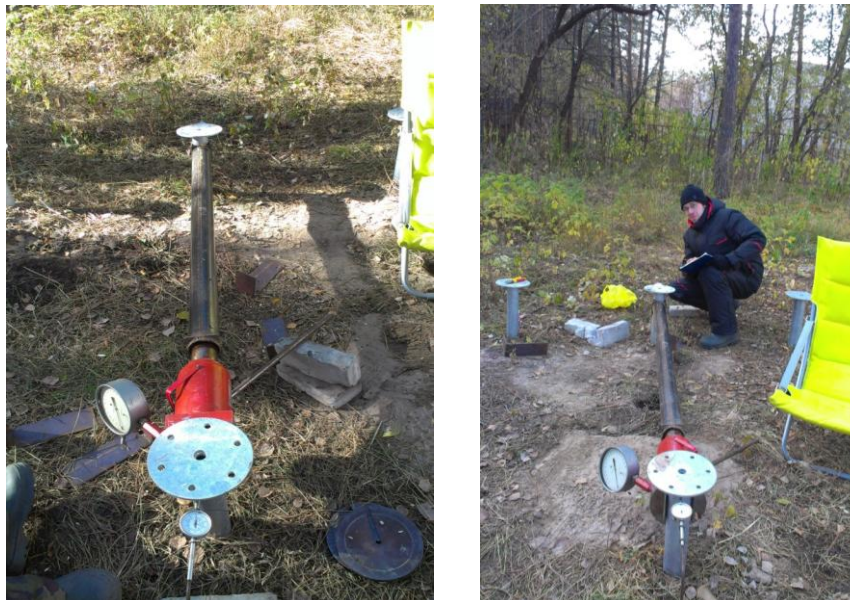
Рисунок 4 - Натурные испытания многолопастных винтовых свай на действие горизонтальных нагрузок.
