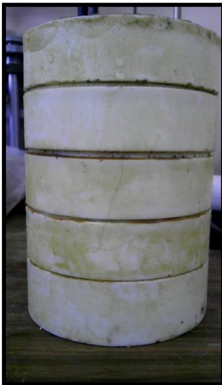
Рисунок 2 – Зазоры между кольцами после испытаний
