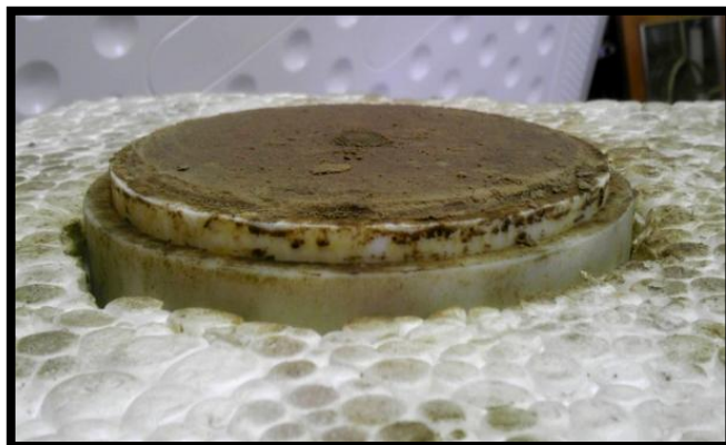
Рисунок 1 – Пучение образца супеси
