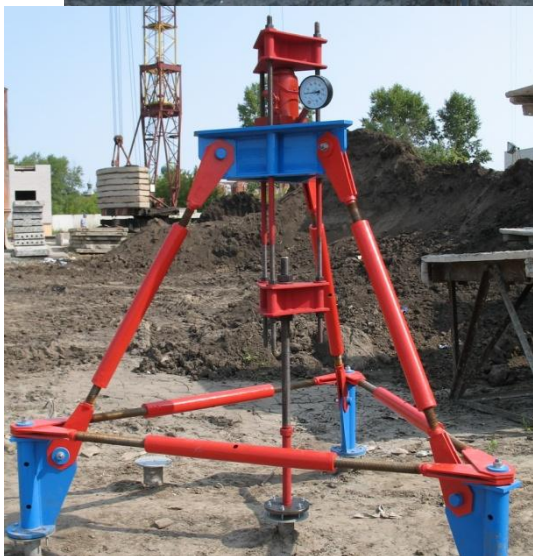
Рисунок 1. Стенд УУ-ВСК в полевых условиях (испытания на вдавливание) выдергивание)
