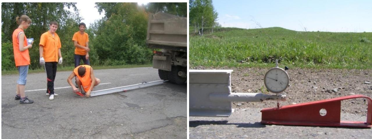
Рисунок 2 – Измерение упругого прогиба автомобильной дороги «Бийск – Мартыново – Ельцовка – граница Кемеровской области» по адресу км 23+310
