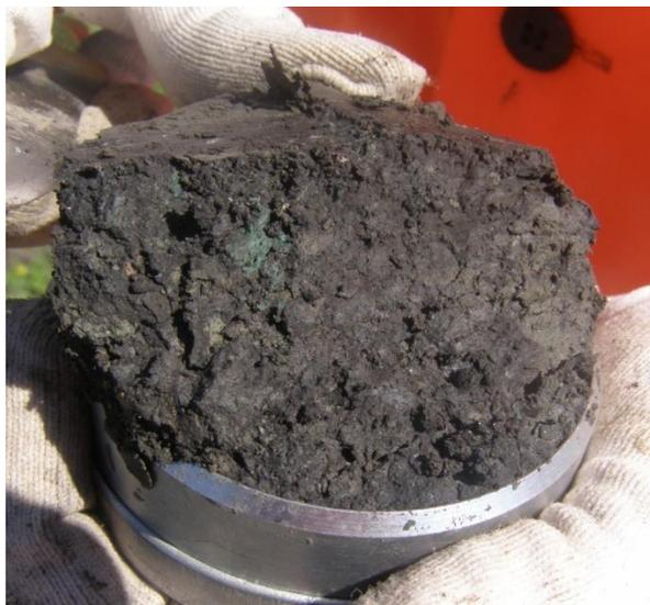
Рисунок 1 – Разработка шурфа и отбор грунта с глубины 1 м на обследуемом участке автомобильной дороги «Алтайское – Ая – Нижнекаянча» по адресу км 6+910
