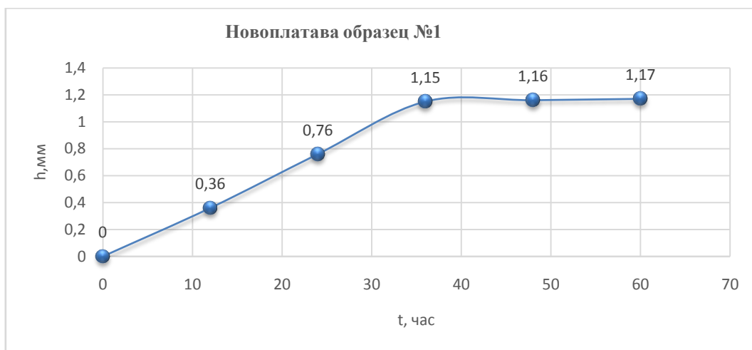
Рисунок 1 - График зависимости деформаций грунта от времени
