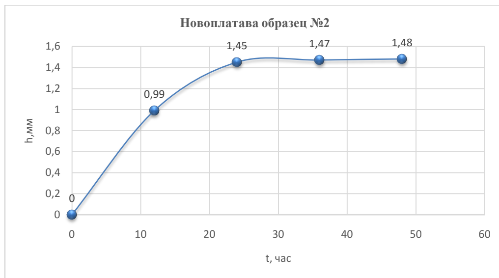
Рисунок 2 - График зависимости деформаций грунта от времени
