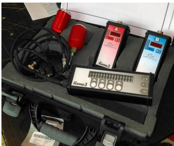
Рисунок 1 – Корреляционный течеискатель «Каскад-3»
