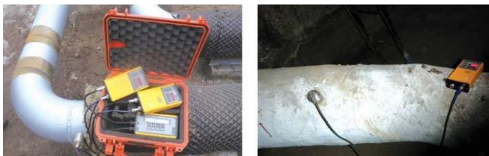
Рисунок 3– Поиск повреждений с помощью прибора «Каскад»
