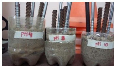
Рисунок 1 – Макеты свай, помещённые в ёмкости с водонасыщенным грунтом
