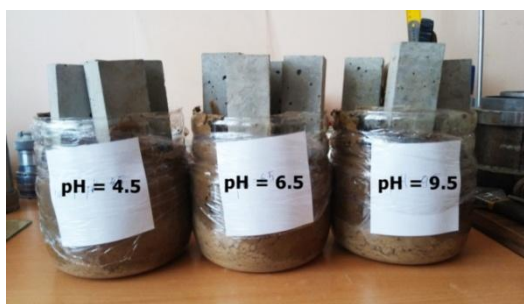
Рисунок 1 – Макеты свай, помещённые в ёмкости с грунтом
