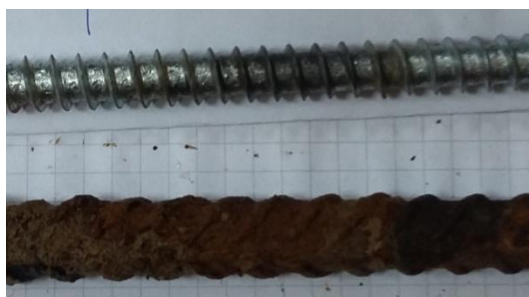
Рисунок 2 – Макеты свай после выемки из агрессивного грунта через 3 месяца
