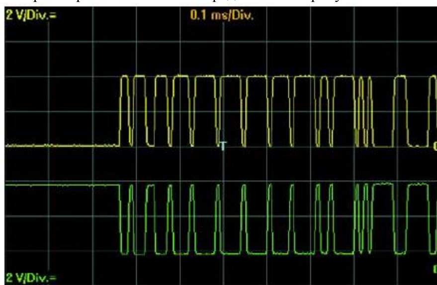
Рисунок 1 – Форма высокого и низкого сигнала CAN - шины
