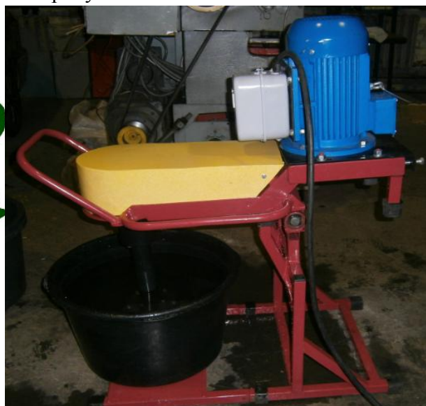
а) пространственная модель УПК – 65б) разработанная конструкция агрегата УПК – 65 Рисунок 2 - Универсальный приготовитель жидких кормовых смесей УПК – 65
