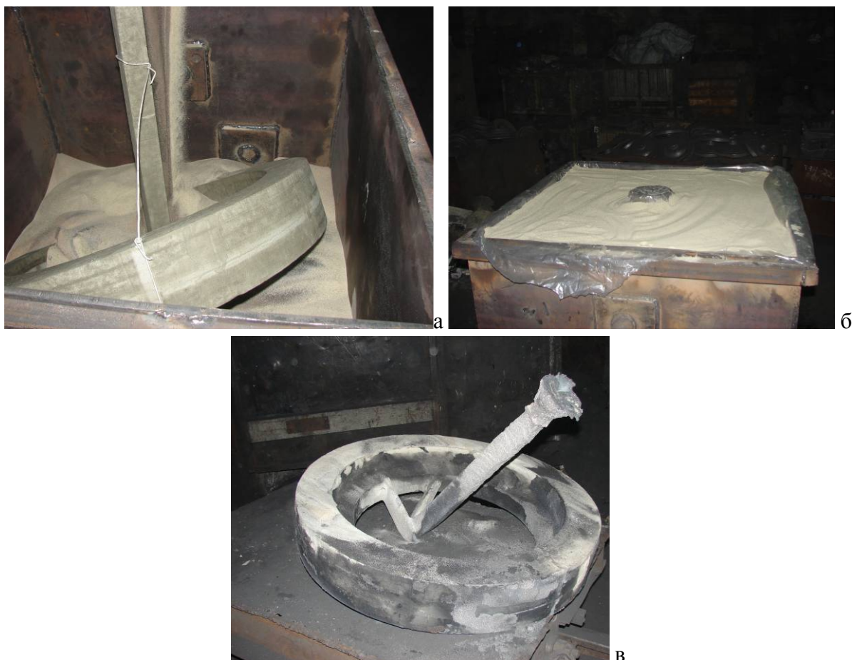
Рисунок 1. Способ литья по газифицируемым моделям.
