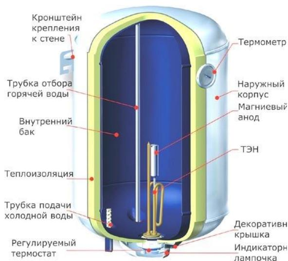
Рисунок 2 – Конструкция электрического накопительного водонагревателя
