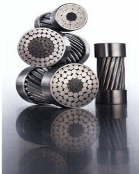
Рисунок 1 – Провод типа АССР – композитный сердечник, алюминиевые жилы, верхний слой из алюминия высокой проводимости
