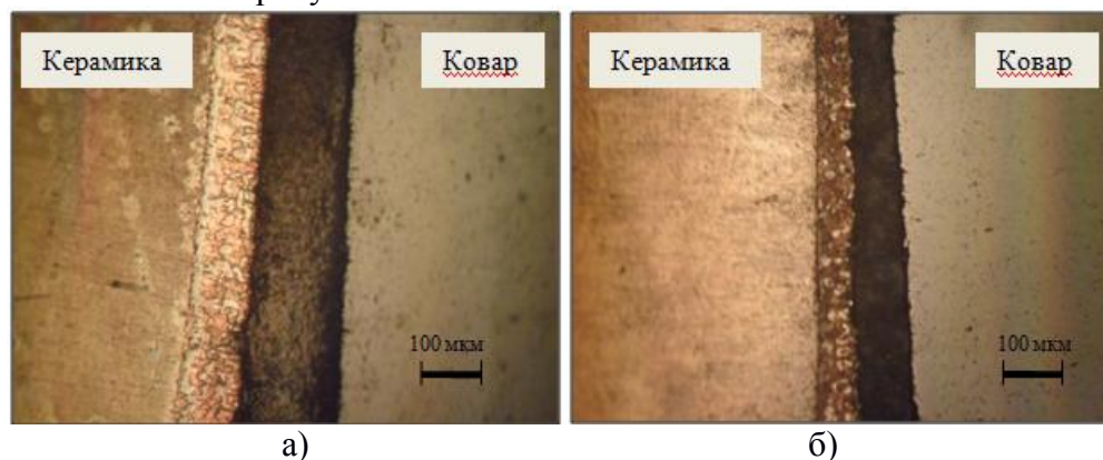
Рисунок 5 – Микроструктура зоны шва паяного соединения, а – до травления, б – после травления
