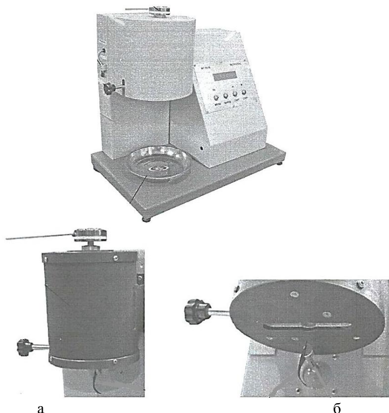
Рисунок 1 – Анализатор индекса расплава МТ 091М, где а – установка, б – экструзионная камера (экструдер)
