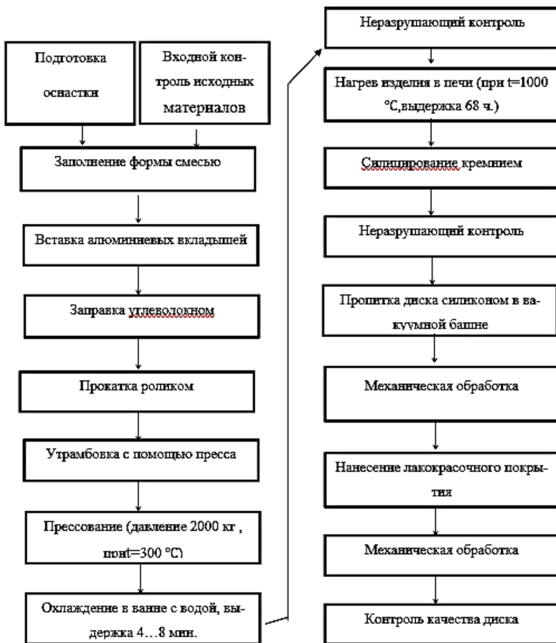
Рисунок 2 – Технологическая схема изготовления тормозного диска
